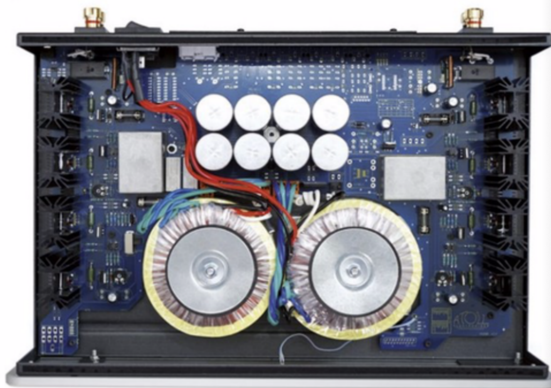
Avec deux transformateurs toriques et un total capacitif assez musclé, l'AM200 est paré pour piloter toutes les enceintes.
