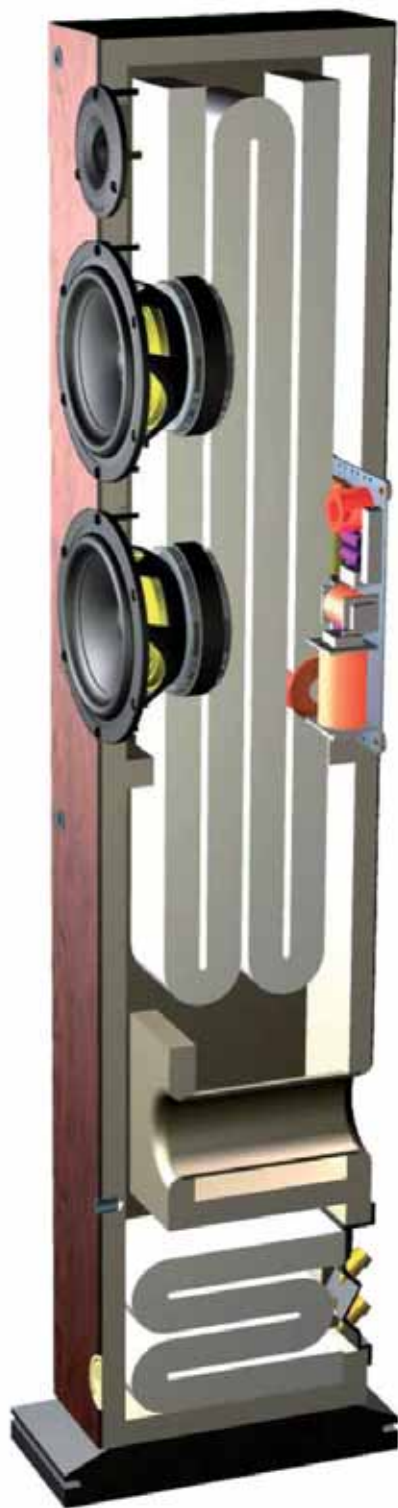
Cette vue en coupe de la Sirocco met bien en évidence le système d'amortissement interne combattant les ondes stationnaires
